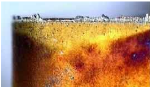
Рис.2. Зношування твердосплавного різця по задній поверхні при ПМО сталі 110Г13Л ( t=6 мм; S=2,04 мм/об; V=15 м/хв; I=180 А; U=140 В)
