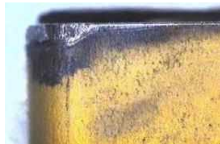
Рис.2. Зношування твердосплавного різця по задній поверхні при ПМО сталі 110Г13Л ( t=6 мм; S=2,04 мм/об; V=15 м/хв; I=180 А; U=140 В)
