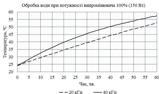
Рис. 1. Графіки залежності температури води від часу обробки при різній частоті ультра-звукових коливань на максимальній потужності генератора (150 Вт)
