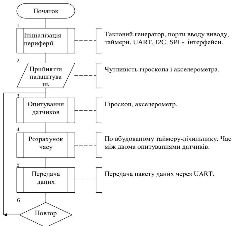
Рис. 1. Алгоритм роботи нижнього рівня інклінометра
