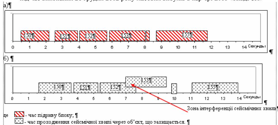
Рис. 2. Часові діаграми масового вибуху а та проходження сейсмічних хвиль б біля житлового будинку (вул. Володарського) під час масового вибуху в кар'єрі ВАТ «ПівдГЗК» 26 грудня 2012 р.
