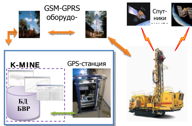
Рис. 3. Структурная схема системы взаимодействия модуля проектирования БВР ГИС K-MINE и системы точного позиционирования буровых станков
