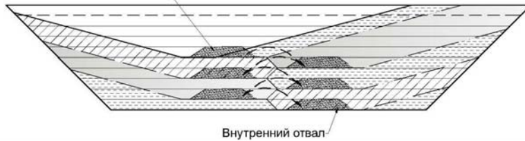
Рис. 2. Схема к определению объемов полезного ископаемого и вскрышных пород при варианте ведения горных работ этапами (при \varphi=\varphi_{\text{max}} )
