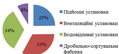
Рис. 2. Балансна діаграма середньоарифметичного значення коливання спожитої електроенергії за видами споживачів на шахтах
