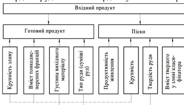
Рис.3. Структура факторів впливу при розділенні вхідного продукту на готовий і піски в механічному односпіральному класифікаторі
