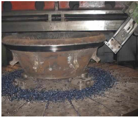
Рис. 1. Оброблення броні конусної дробарки на токарно-карусельних верстатах
