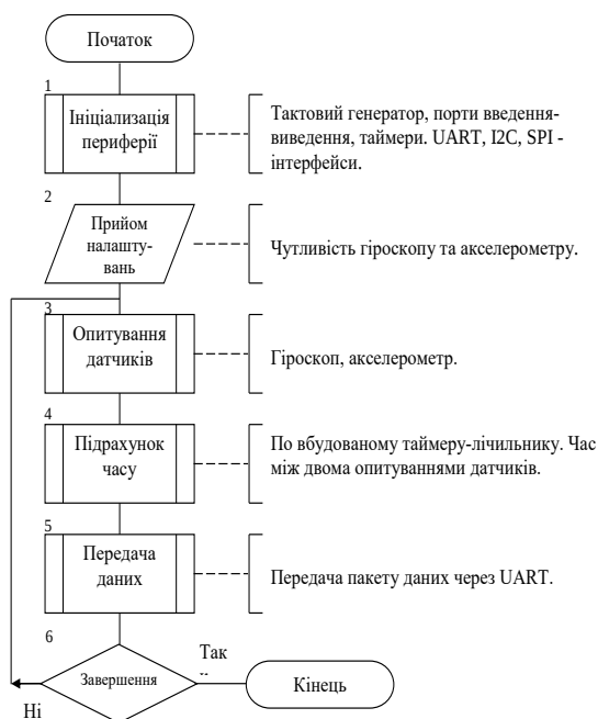
Рис. 3. Блок-схема алгоритму нижнього рівня
