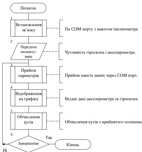
Рис. 4. Блок-схема алгоритму верхнього рівня
