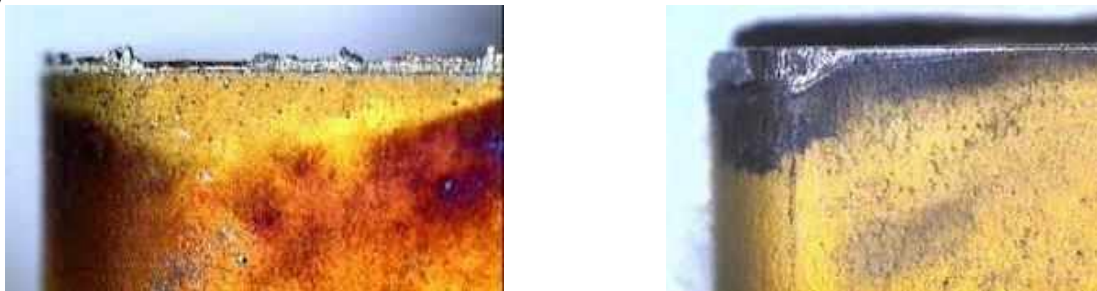
Рис.2. Зношування твердосплавного різця по задній поверхні при ПМО сталі 110Г13Л ( t=6 мм; S=2,04 мм/об; V=15 м/хв; I=180 А; U=140 В)
