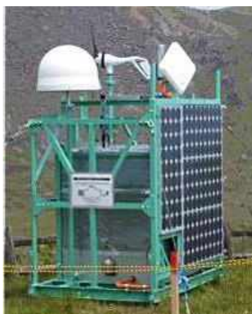
Рис. 9. REGMOS / (Станція дистанційної системи моніторингу GNSS)
