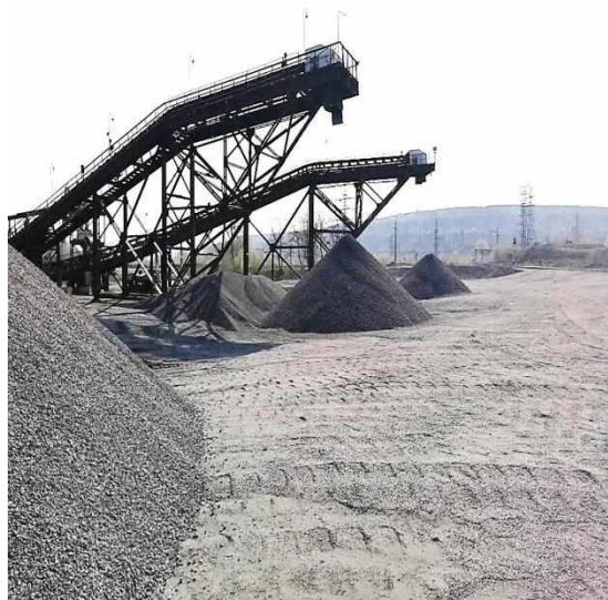
Рис. 1. Процес розподілу на фракції щебеню з відходів сухої магнітної сепарації
