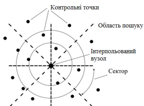
Рис. 6. Розрахунок інтерполюваного вузла у 3D-просторі
