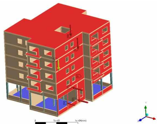
Рис. 3. Математична модель будівлі та схема розподілу навантажень
