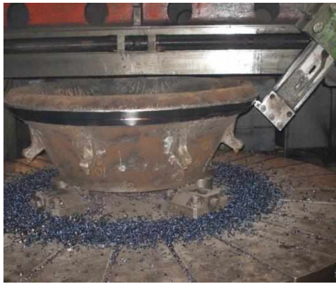
Рис.1. Оброблення броні конусної дробарки на токарно-карусельних верстатах
