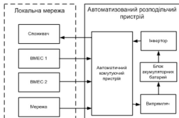
Рис. 2. Структурна схема системи локальної електропостачання на базі відновлювальних джерел електроенергії
