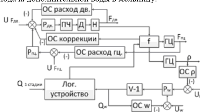
Рис. 3. Алгоритмическая структурная схема системы управления при детерминированных параметрах
