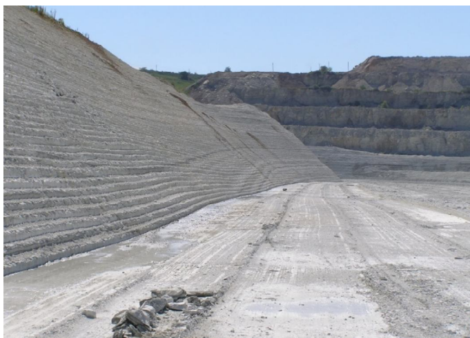
Рис. 1. Укіс уступу після відпрацювання кар'єрним комбайном фрезерного типу
