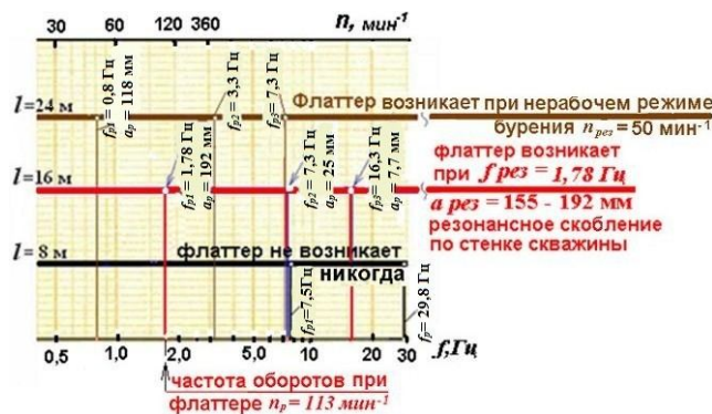
Рис. 2. Флаттер бурового инструмента на буровых ставах различной длины
