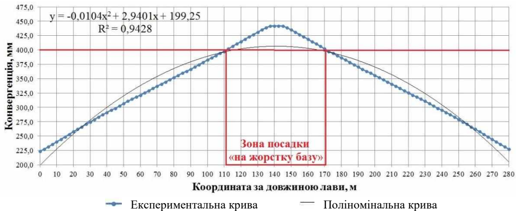
Рис. 1. Характер розподілу конвергенції уздовж 863 лави ПК 207 під час посадки секцій механізованого кріплення «на жорстку базу»
