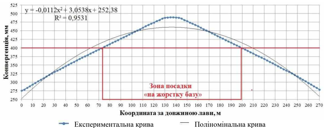
Рис. 3. Характер розподілу конвергенції уздовж 1174 лави ПК 47+5 м під час посадки секцій механізованого кріплення «на жорстку базу»
