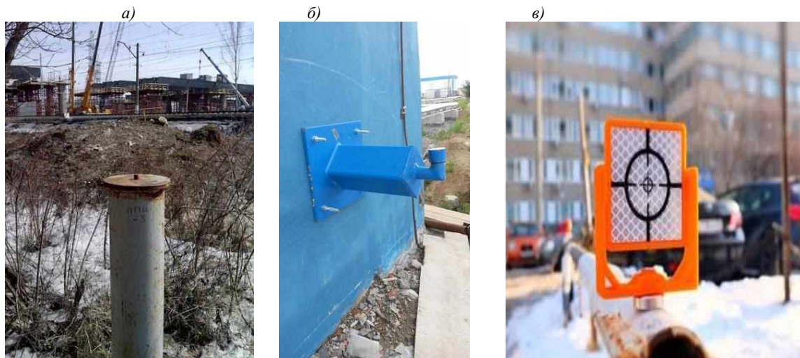
Рис. 2. Пункти опорної мережі геодезичної системи моніторингу (а); осадочні марки (б); деформаційні марки (в)
